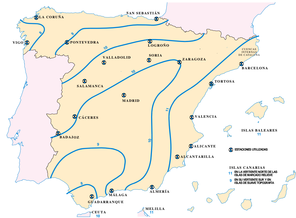
Figura 4. Relación entre las intensidades de lluvia horaria y diaria (I1/Id). Mapa de isólinas I1/Id (Fig. 2.2. de la Instrucción)
